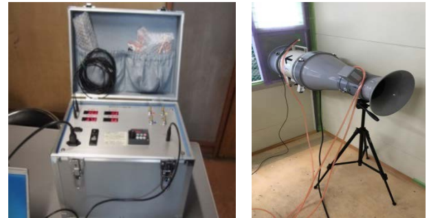
写真1 建物気密性自動多点計測システム
